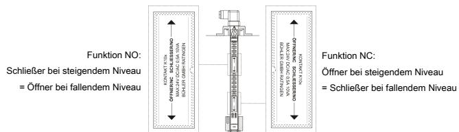
Die Kontaktlogik geht davon aus, dass der Niveauschalter in einen leeren Tank installiert wird d. h. er ist erst nach dem Befüllen in der Betriebsposition.
