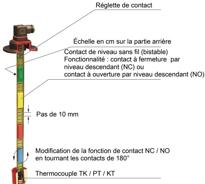
Les contacts actionnés par le flotteur sont montés avec des vis en plastiques sur un réglette de contacts à dorure galvanique avec échelle en cm. Les boîtiers de contact sont de couleur différente et ils ne doivent être montés sur la réglette de contacts que dans l'ordre suivant.
