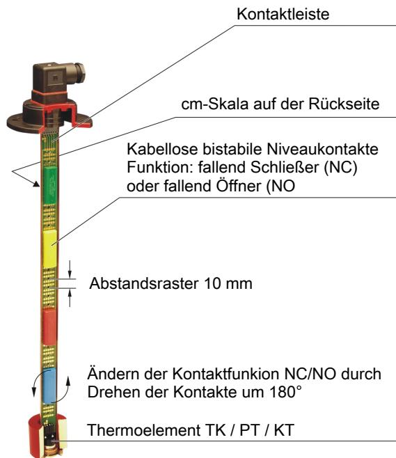
Die vom Schwimmer betätigten Kontakte sind auf einer galvanisch vergoldeten Kontaktleiste mit cm-Skala mit Kunststoffschrauben angebracht. Die Kontaktgehäuse sind verschiedenfarbig ausgeführt und dürfen nur in folgender Reihenfolge auf die Kontaktleiste montiert werden.
