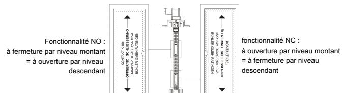
La logique de contact suppose que l'interrupteur de niveau est installé dans un réservoir vide, ce qui signifie sa mise en service après avoir été rempli.
