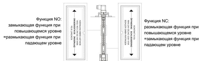
Логика, используемая в контактах, исходит из того, что реле уровня устанавливается при пустом резервуаре, т. е. оно будет находиться в рабочем положении только после наполнения резервуара.
