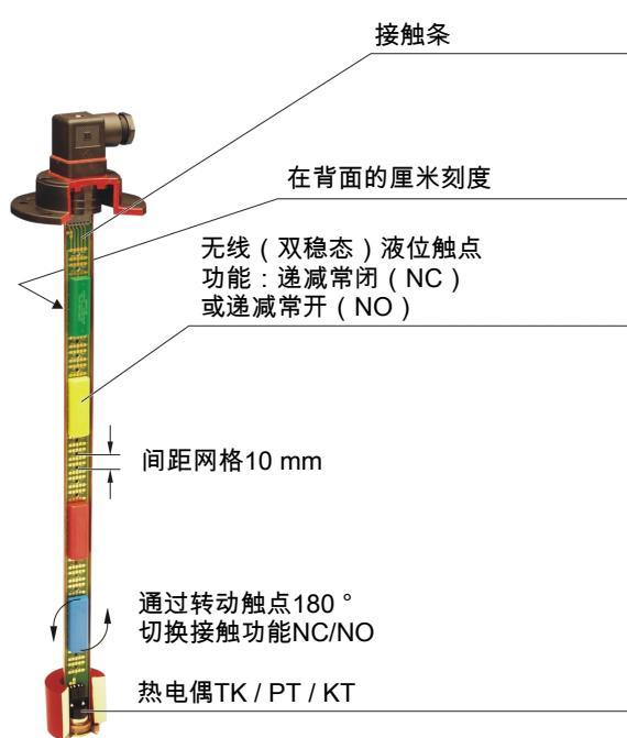
借助塑料螺丝，由浮子致动的触点被安装在刻度为厘米的镀金接触条上。触点外壳被设计成各种颜色，只能按照以下顺序被安装在接触条上。
