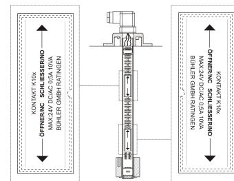
触点逻辑假定，液位开关安装在一空罐中，即灌装后才在工作位置。
