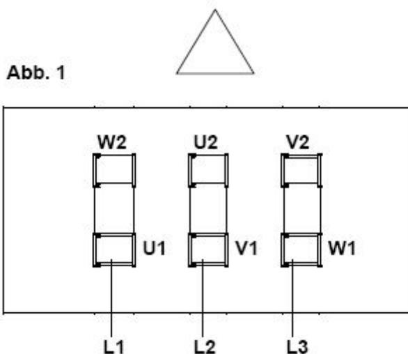
Eine Änderung der Drehrichtung wird durch das Umwecheln von zwei beliebigen Phasen herbeigeführt.
