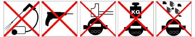
Изображение 4: Недопустимая механическая нагрузка
