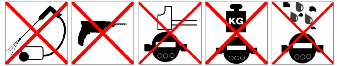
图4: 不被允许的机械应力
