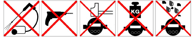
Abb. 4: Unzulässige mechanische Beanspruchung
