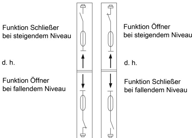
Die Kontaktlogik geht davon aus, dass der Niveauschalter in einen leeren Tank installiert wird, d. h. er ist erst nach dem Befüllen in der Betriebsposition.
